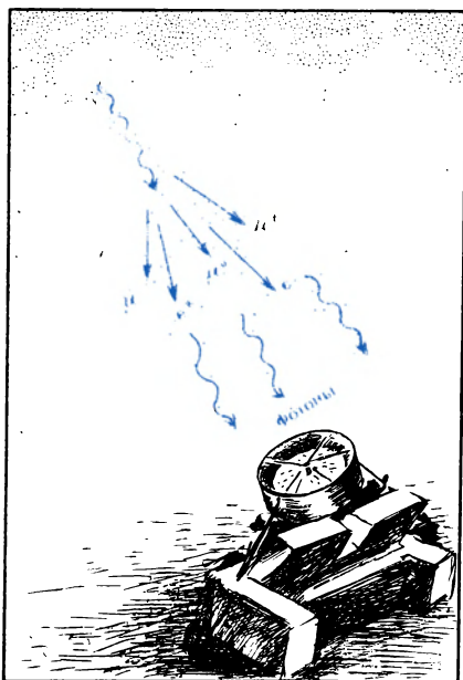
Схема регистрации сверхжестких космических гамма-квантов, порождающих в земной атмосфере черенковское свечение
